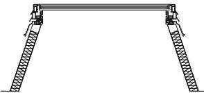
Kingspan ESSMANN Flachdachfenster mit thermisch getrenntem Stahl-Aufsetzkranz AK ST-TG in 50 cm Höhe
