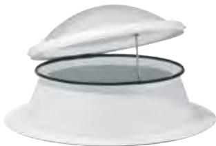
Die runde Kingspan ESSMANN Lichtkuppel LK R classic, starre Ausführung, besteht aus einer hochwertigen, standardmäßig opal eingefärbten Kunststoffverglasung (3- oder 4-schalig), die direkt auf einen GFK-Aufsetzkranz geschraubt wird. Die lüftbare Ausführung besteht aus einer hochwertigen, opal eingefärbten Kunststoffverglasung, die mit einem stabilen Lüfterrahmen versehen ist, mit dem sie auf einem GFK-Aufsetzkranz befestigt wird.
