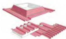
Traufwärts werden die vorhandenen Dachprofile mit einem Schuhprofil überdeckt (die Sicken durch bauseitige Füller geschlossen), die seitlichen Längsränder sind auf das von Ihnen gewählte Profil abgestimmt. Firstseitig wird der ebene Teil des Aufsetzkranzflansches unter das Dachprofil geschoben oder mit einem bauseitigen, vom First kommenden Zulageblech (Füller bauseits) überdeckt.
