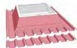
Der gemäß individuellem Bedarf hergestellte, vollprofilierte Aufsetzkranz AK MPA wird an den seitlichen Rändern zur Überdeckung des Obergurtes trauf- und firstseitig mit 20 cm Flanschlänge geliefert. Damit auch alles passt, fragen wir vor der Fertigung die Verlegerichtung, Profiltyp, Profilrichtung und Weiteres ab. So ist sichergestellt, dass Ihr Aufsetzkranz perfekt zum Profil passt.
