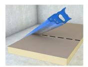
Der Zuschnitt kann mit einer feinzahnigen Handsäge oder Kreissäge erfolgen.
