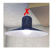
■ Lampen o. ä. sollten vor der Montage der Therma<sup>™</sup> TR27 Flachdachplatte verwendet als Unterdachplatte durch einen Elektroinstallateur demontiert werden, um eine vollflächige
