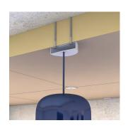
■ Die Therma<sup>™</sup> TR27 Flachdachplatten haben keine tragende Funktion. Befestigen Sie Lampen o. ä. daher niemals an den Therma<sup>™</sup> TR27 Flachdachplatten, wenn Sie diese als Unterdachplatte verwenden. Sondern verankern Sie diese mit geeignetem Befestigungsmaterial durch die Therma<sup>™</sup> TR27 Flachdachplatte in der tragenden Decke. Achten Sie darauf, dass Sie keine verdeckten Leitungen (Strom, Wasser usw.) beschädigen.
